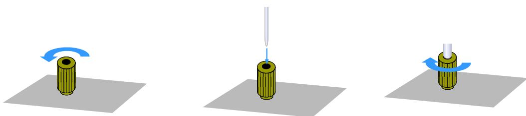
インク供給パイプを、ネジを緩めた接続金具に底まで(1cm程度)挿入後、接続金具のネジをしっかりと締めて下さい。
