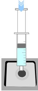
6リザーバータンク内に冷却水が満たされた後、冷却水デリバリーパイプの気泡の有無を確認して下さい。気泡がある場合にはパイプを指で良く揉んで、気泡をリザーバータンク側へ追い出して下さい。必要があれば再度リザーバータンク内へ冷却水を補充して下さい。
